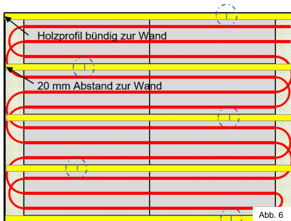
Die Profileleisten werden versetzt eingelegt (Abb6)
