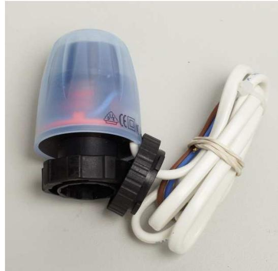
**Anwendung** Elektrothermische Stellantriebe in der Betriebsart stromlos geschlossen (NC). Die Stellantriebe öffnen und schließen die Ventile am WEM Heizkreisverteiler. Sie werden von den WEM Raumthermostaten angesteuert und ermöglichen eine individuelle, bedarfsgerechte Temperaturregelung.
