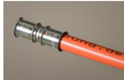
Presszange rechtwinklig auf den Fitting aufsetzen. Der Pressvorgang ist beendet, wenn die Maschine automatisch abschaltet oder bei Handhebelpressen bis zum Anschlag durchgedrückt wurde.
