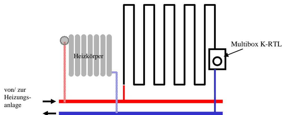
Wenn mehr als zwei Heizkreise abgesenkt werden müssen, stoßen die RTL-Ventile aus hydraulischen Gründen an ihre Grenzen.
