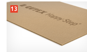
GUTEX Happy Step Basisplaat voor verhoogd loopcomfort en contactgeluidisolatie bijv. bij parket
